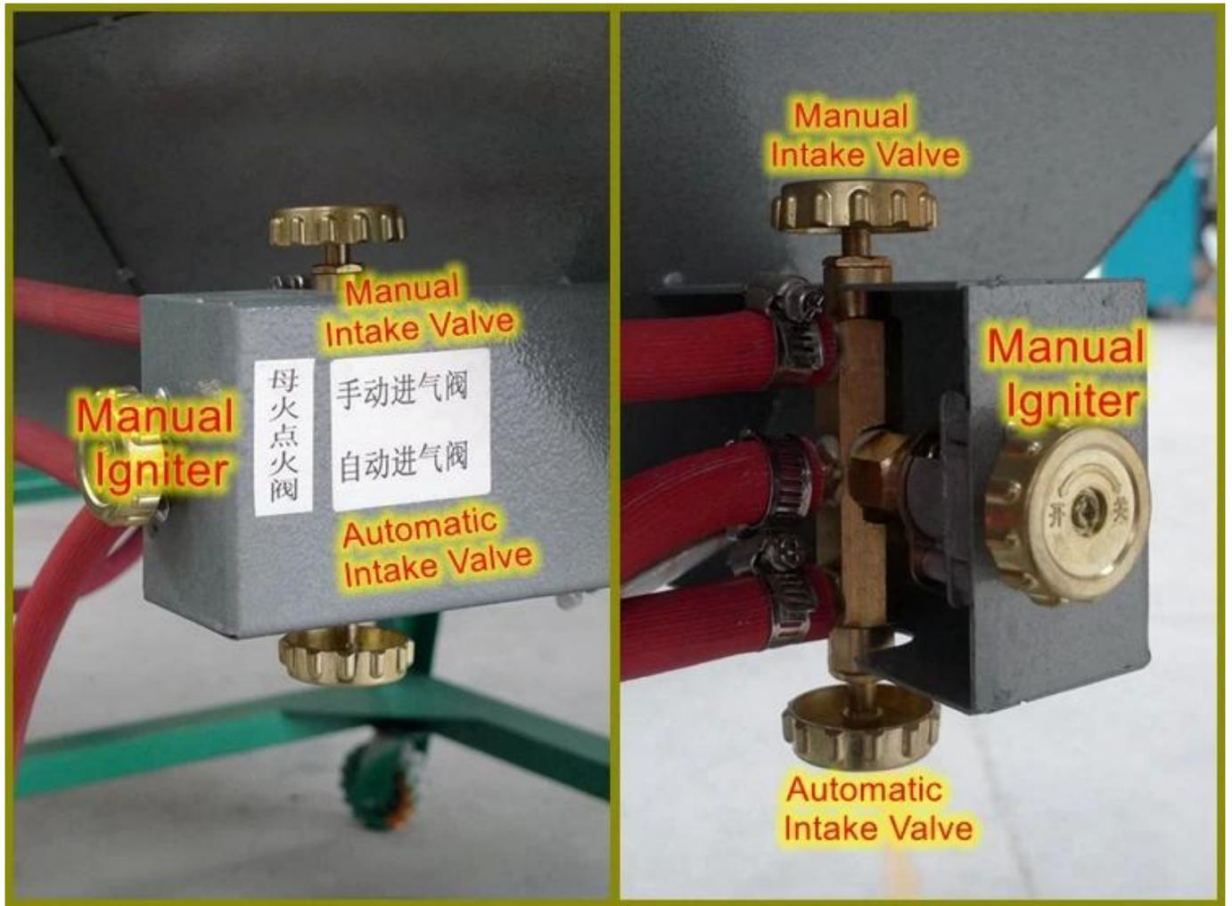
此装置用于控制燃烧器的运行，通过手动和自动进气阀调节燃气流量，并由手动点火器点燃。该装置通常安装在燃气灶具或工业燃烧设备上，以确保安全和稳定的燃烧。
